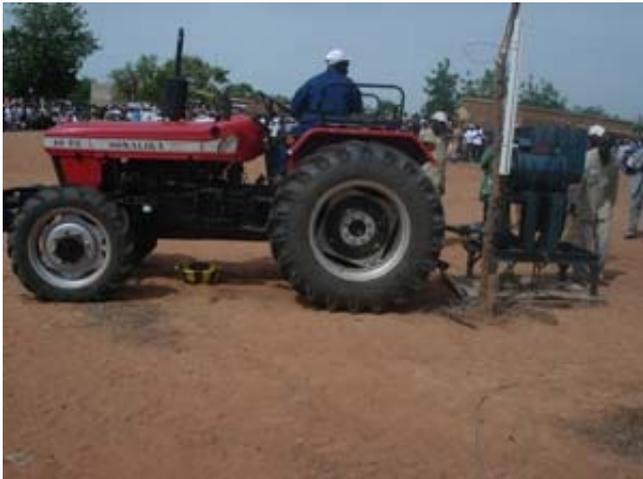
*Démonstration de la production d'électricité par un tracteur*
